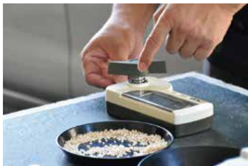
少量のお米を検査機にかけ、水分量を測定
