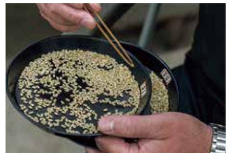
被害粒、死米、着色粒などをピンセットで下皿に移し、それぞれの重さから整粒割合を計算します
