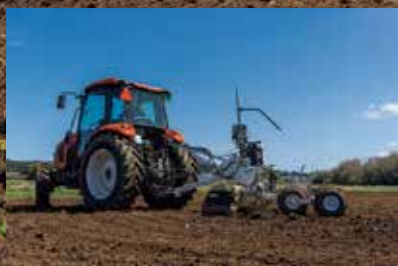
チゼルと呼ばれる爪が土を砕き乾燥を早めます。
